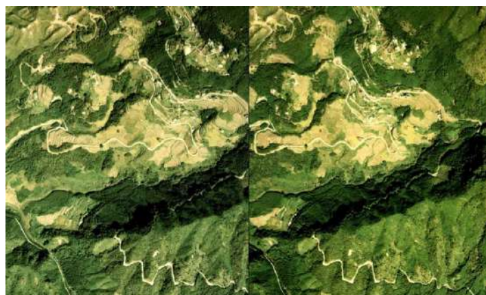
Fotografías aéreas tomadas en dos puntos desplazados. 79
